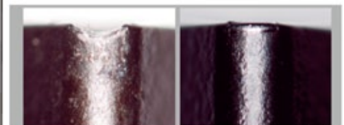
無処理 ブライト処理施工 逃げ面
