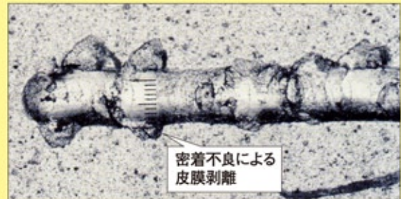
PVD処理単体 密着不良による皮膜剥離
